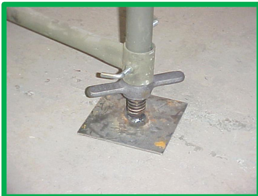
FOTO Nº 20 Sistema de regulagem da sapata metálica.
